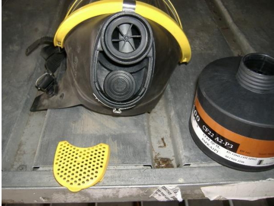
foto: inlaatventiel is duidelijk vergaan
