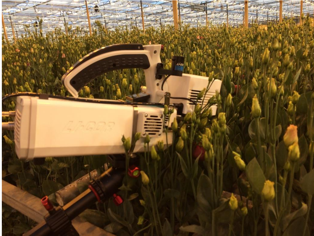
Foto 1. Meting van de fotosynthese met een draagbare fotosynthesemeter (LI-6800) bij Lugt Lisianthus (Honselersdijk). In het apparaat kunnen PAR, CO 2 , temperatuur en vocht gevarieerd worden. Op deze manier is de fotosynthese-snelheid gemeten bij oplopend PAR of CO 2 aan ingeklemde bladeren.
