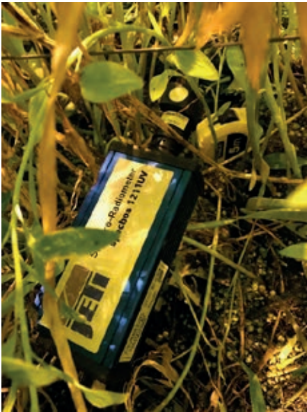
Figuur 6 Lichtonderschepping is bij lamplicht – winter meting- met de Jeti op vier verschillende hoogtes van het gewas gemeten.
