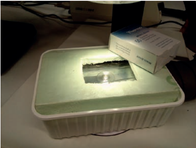
Fig. 3.1. Koelmachine en koelblok die zijn gebruikt voor het meten van loopactiviteit bij roofmijten.
