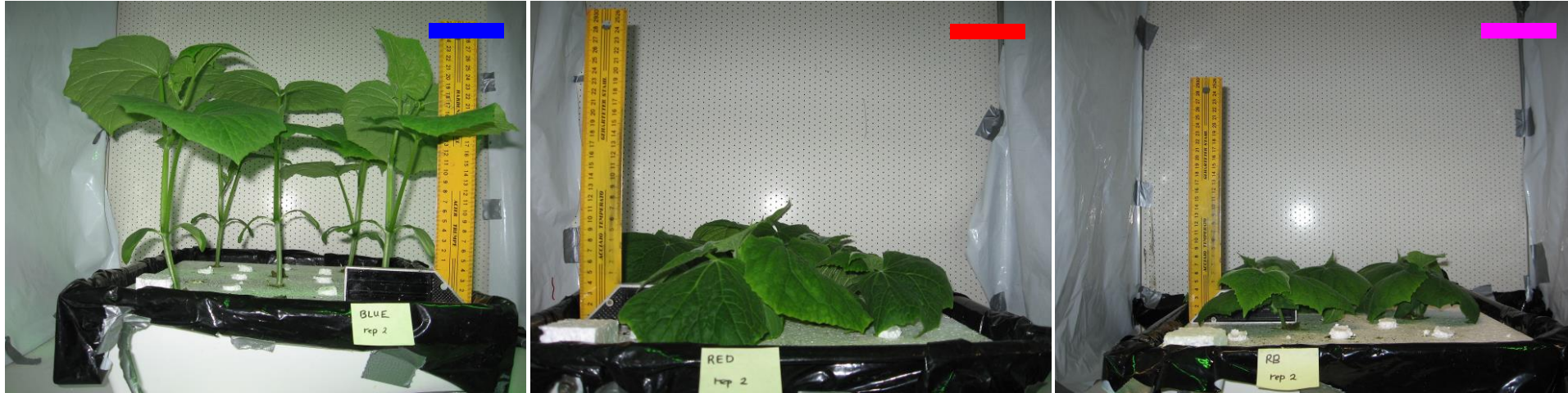
Fig. 5. Komkommer ontkiemd onder TL-licht en vervolgens geplaatst in een klimaatkamer onder 100% blauwe LED's (links), 100% rode LED's (midden), en een combinatie van deze twee LED-typen (rechts). De lichtintensiteit was gelijk ( 100 \mu\text{mol}/\text{m}^2\text{s} ; 16/ 8 uur dag/nacht). De lengte van de planten na 16 dagen groei was respectievelijk 17.7, 6.5 en 5.5 cm voor 100% blauw, 100% rood en gecombineerd rood/blauw. (onderzoek Hogewoning en van Ieperen uit 2008, ongepubliceerd).
