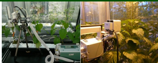
Foto 1. Meting van CO 2 -benutting met het LI-6400XT Portable Photosynthesis System. Links: Meting aan een paprikabladdat al aangelegd was bij de plantenkweker. Rechts: Meting aan een blad dat ontwikkeld is in de onderzoekscabine.
